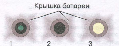
Рис. 1. Показания индикатора плотности электролита: 1 – темный индикатор с зеленой точкой – батарея заряжена; 2 – темный индикатор без зеленой точки – батарея разряжена; 3 – прозрачный или светло-желтый индикатор – низкий уровень электролита
